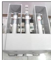
4. Блок предохранителей в собранном состоянии
