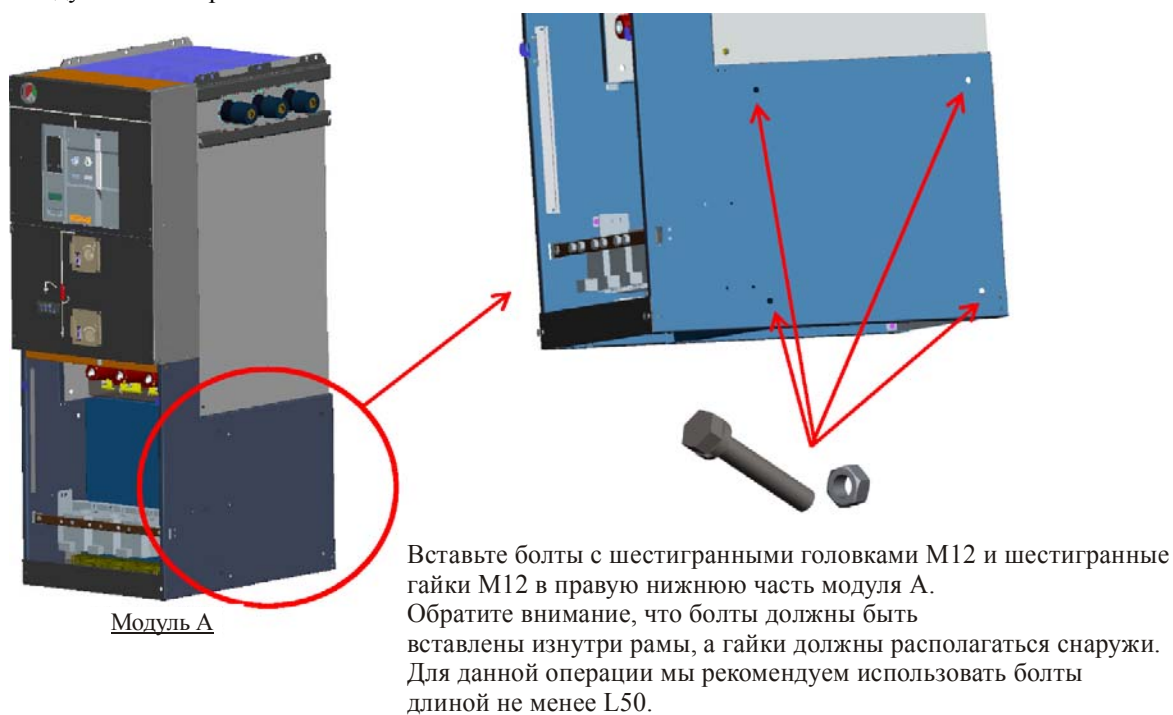
[Рис. 11-5] Подготовка к установке блоков расширения
