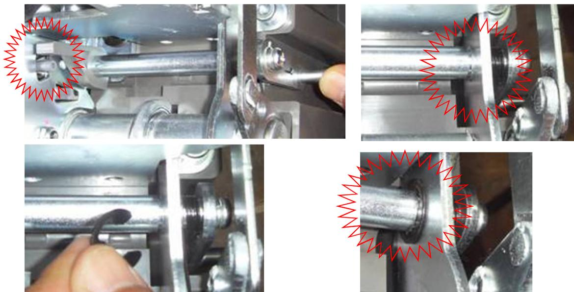
6. После того, как положение блокировочного штока зафиксировано, повторно проверьте плавность его хода
